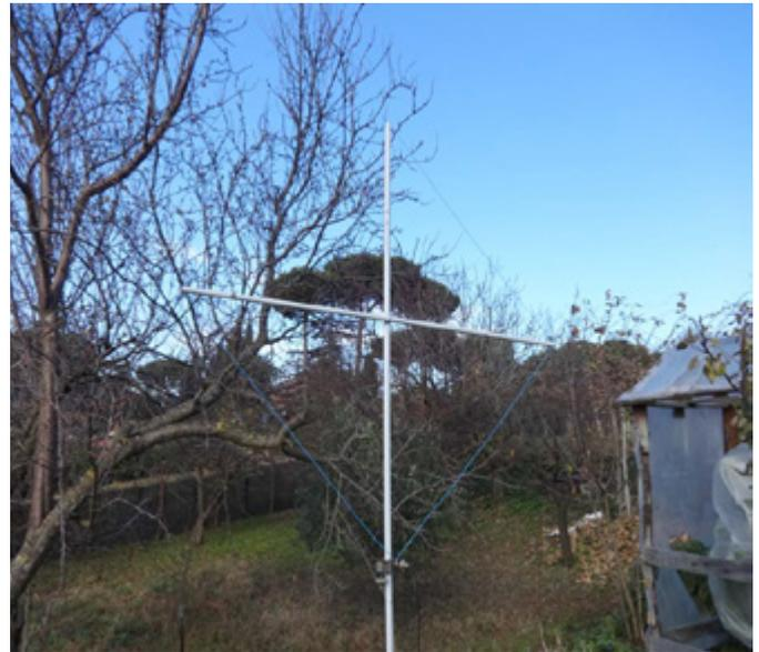
Ho quindi costruito una Loop Magnetica, adatta per funzionare sia in 40 che 80 metri, mediante l’accordo con un condensatore variabile.
