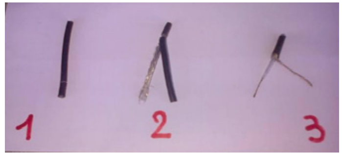
FOTO 1 : PREPARAZIONE DEL CAVO COASSIALE
