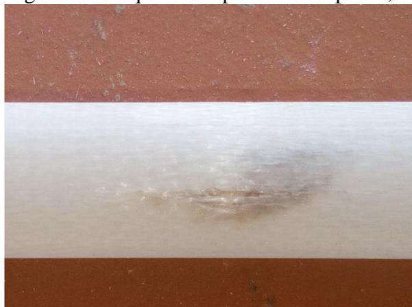
vetroresina, se non protetta, assorbe l'umidità, deteriorandosi molto velocemente ed irrimediabilmente. Purtroppo, in prossimità della punta, la fibra di vetro era molto esposta e si è sfaldata al punto di risultare forata.
