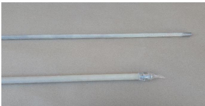
Le zone con la vetroresina esposta sono state ricoperte con adesivo epossidico bicomponente, tipo Araldite, che una volta asciutto garantisce protezione e robustezza strutturale.
