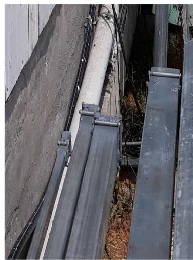
Eseguito il posizionamento dei rulli si arriva quindi alle prove di movimento telescopico delle varie sezioni e quindi al successivo posizionamento e montaggio delle ruote di scorrimento dei cavi di trazione.
