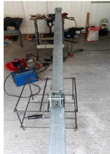
Realizzati i supporti delle ruote per i cavi di trazione sono state aperte delle feritoie per consentire lo scorrimento delle ruote per 0,5 cm all'interno di ogni singolo palo che deve subire l'innalzamento e, dato che la gola delle ruote è di 0,5 cm e il diametro del cavo è il medesimo non si hanno perdite di spazi all'interno dei sistemi di innalzamento.
