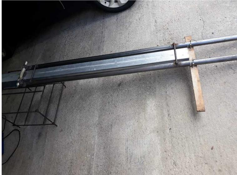
Ed infine è stato costruito il telaio di supporto del verricello per l'innalzamento del palo e fissato sempre sulla prima sezione.
