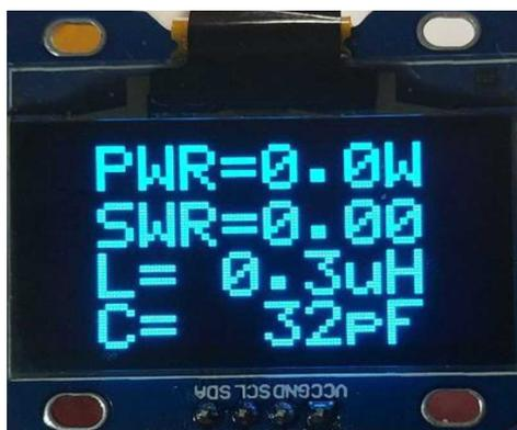
Teniamo comunque conto che il suo funzionamento è automatico, ovvero quando vede RF in ingresso attiva autonomamente l'accordatura senza bisogno di intervento da parte dell'operatore, e memorizza la configurazione.
