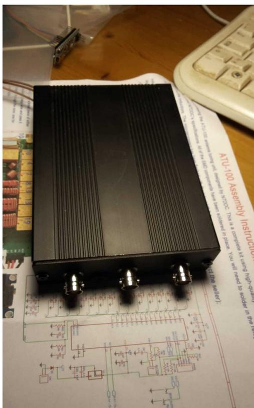
Si vedono 3 connettori BNC, anziché due, perchè ho approfittato del contenitore per inserire un commutatore manuale tra due antenne (nel mio caso una verticale per 208MHz e un dipolo per i 10MHz)
