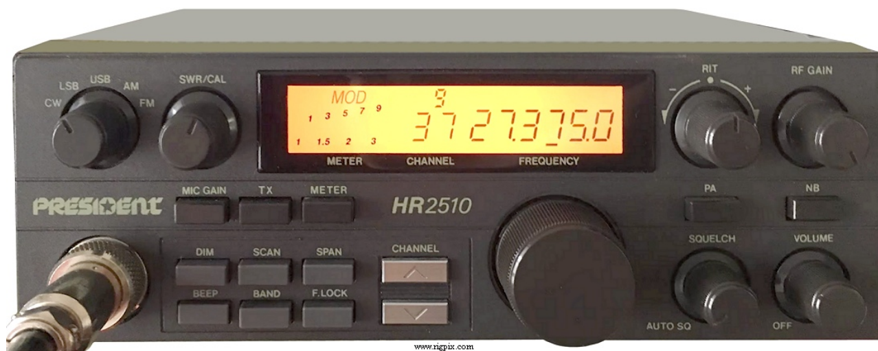
President Uniden HR2510 senza tasti colorati e con RF Gain al posto del RF Power.
