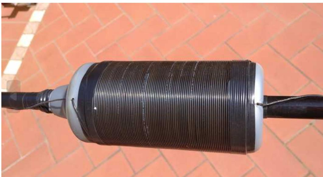
Una volta assieme l’antenna, e posta su di un adeguato sistema di radiali... appoggiati a terra o sollevati (vedi anche l’articolo “Una Verticale nella rete ...“, non resta che realizzare la taratura accorciando o allungando il tratto di filo al di sopra della bobina.
