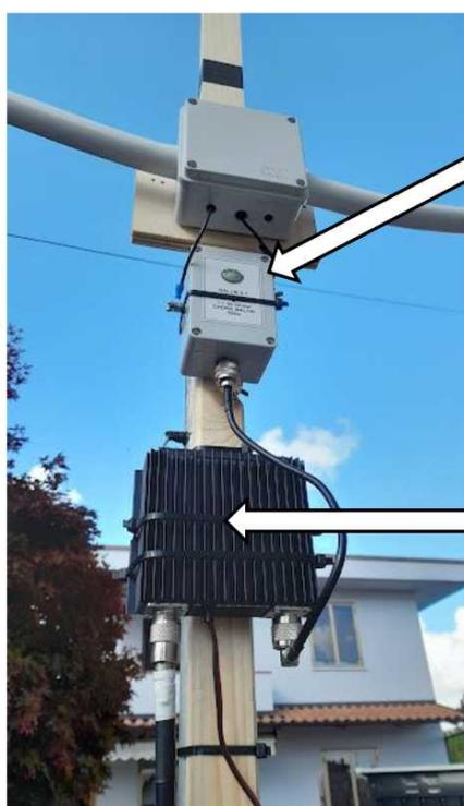
Trasformatore d'impedenza 9:1 in tensione con RF Choke 1:1 in serie a valle, spire avvolte su toroide
