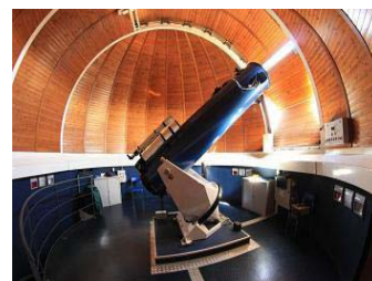
Telescopio T.65 - D. 650 mm * F. f/5 equipaggiato con N°3 sensori C.C.D.
