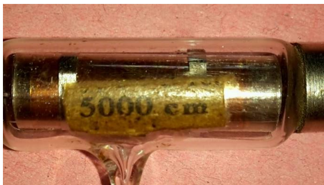
Un raro condensatore da 5000 centimetri (quando la capacità elettrica non si misurava ancora in Farad - 5000 cm sono circa 5560 pF)
