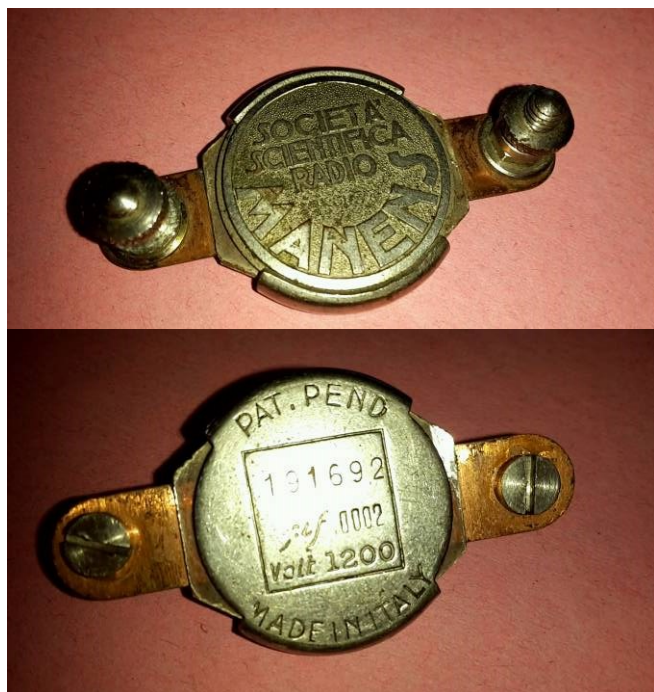
Un raro condensatore a mica Manens come quello che si guastò nella Ondina33 di Biagi al Polo nel 1928 e che venne subito riparato (non come racconta il film circa il resistore riparato con la matita)
