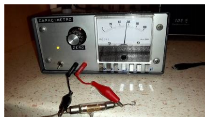
Un raro condensatore da 5000 centimetri (quando la capacità elettrica non si misurava ancora in Farad - 5000 cm sono circa 5560 pF)
