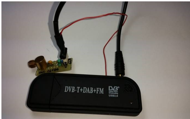
La chiavetta e il suo preamplificatore
