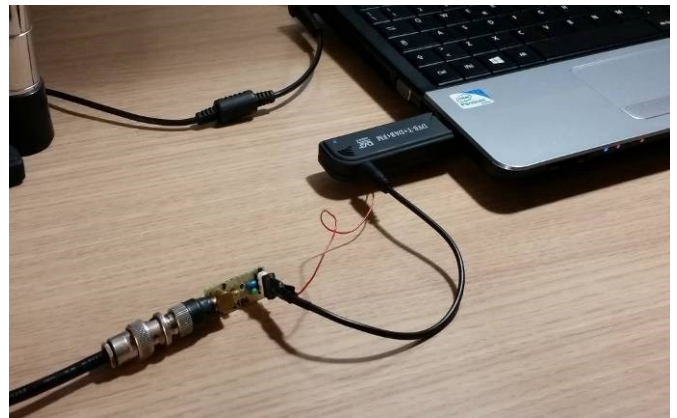
La chiavetta e il suo preamplificatore in azione
