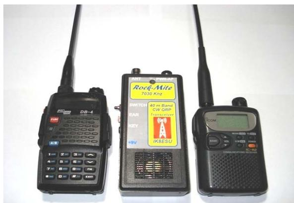
Le dimensioni del “Rock-Mite” rapportate ad altri due nani, il palmare bibanda VHF-UHF Polmar DB-4 e lo scanner Icom IC-R2
