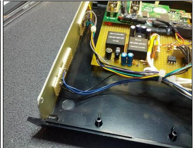
Una volta assemblato il tutto, vi troverete i cavi dei segnali che vi interessano (TX,RTTY,CW, AUDIO IN, AUDIO OUT, ...) che andrete a saldare sul connettore DB25.
