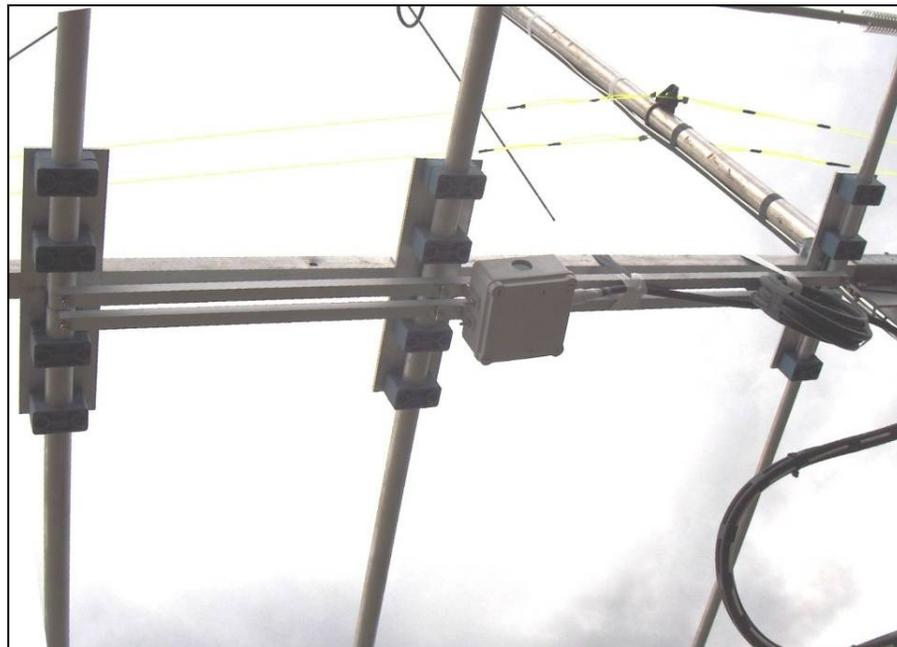
Dettaglio del balun 1:1 montato sotto il radiatore dei 15 metri
