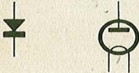
ha il predominio di un'alternanza sull'altra. Il sistema raddrizzatore lascia, per es., passare la corrente 500 o 1000 volte più facilmente in un senso che nell'altro. Gli effetti prodotti sono, dunque, superiori, e tutto avviene — a parte il rendimento inferiore — come se il raddrizzamento fosse perfetto.
