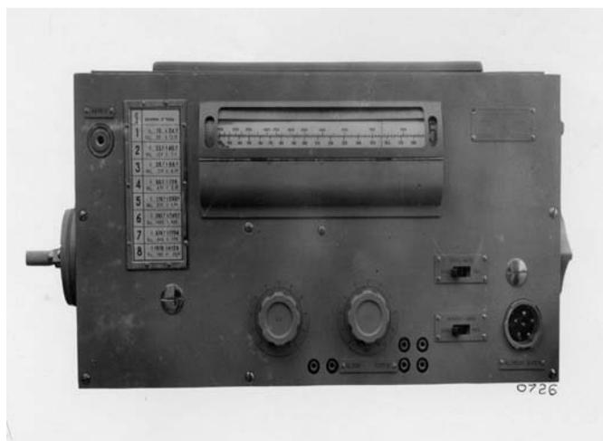
Rx Allocchio & Bacchini AC-14 – da 75 a 20.000 kHz
