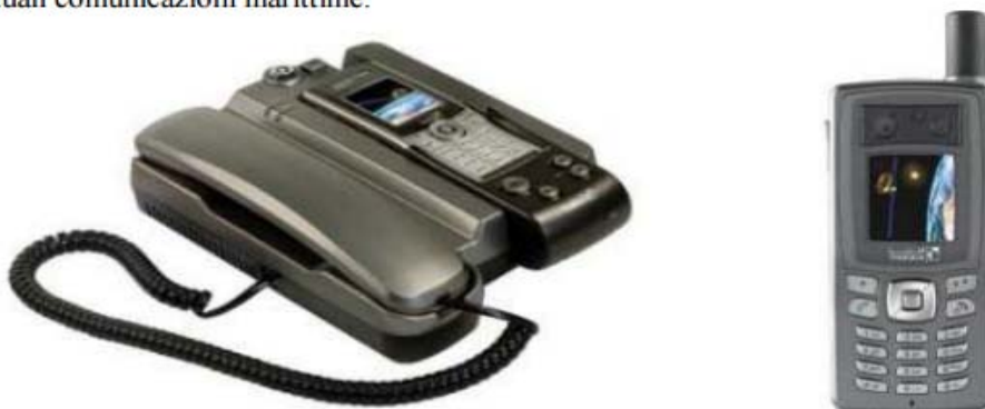
Figura 6. Due modelli di telefono satellitare, il primo da interno, il secondo portatile.
