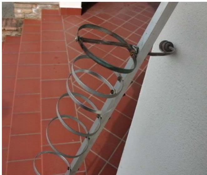
Essendo un'antenna con l'attacco esterno, il peso potrebbe, con il tempo, abbassare l'antenna e piegarla con la punta verso il basso; a questo scopo si consiglia di mettere un tirante di nylon dalla punta a sopra l'attacco dell'antenna al palo (master).
