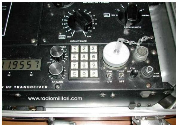
Nel caso di riscaldamento eccessivo del trasmettitore, la potenza viene automaticamente ridotta a 10 W.
