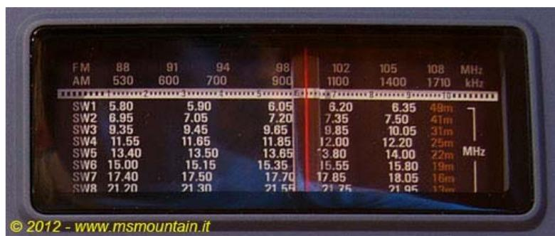
Selezione bande FM - AM (MW) - SW in una radio multi banda (Etòn FR350) con sintonizzatore analogico
