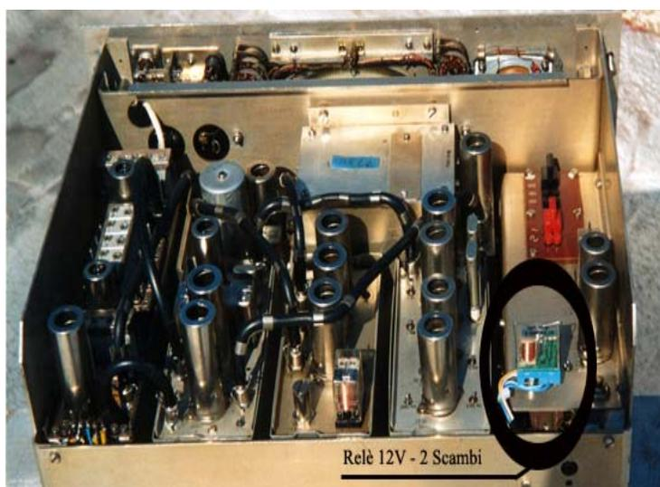
del potenziometro di regolazione della tensione anodica degli oscillatori, tenendo in debito conto le dimensioni dello zoccolo relè (vedi immagini). In questo foro filettato si avviterà la porzione filettata di una colonna alta 2 cm. Su essa si avviterà lo zoccolo del relè. Un piedino dello zoccolo riguardante l'alimentazione bobina del relè andrà collegata a massa con paglietta sotto la colonnina.
