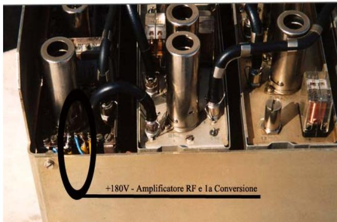
L'altro piedino dello zoccolo riguardante il + di alimentazione bobina relè andrà con un cavetto a collegarsi al terminale distale isolato del connettore ZF del pannello del ricevitore.
