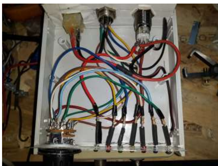
(Unità di controllo remoto con - selettore 6 posizioni 2 vie - interruttore e indicatori led alta luminosità - connettore microfonico di alimentazione)
