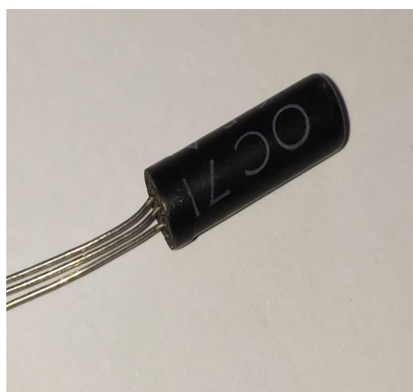
“OC71”, uno tra i primi transistor con dimensioni e costo contenuto
