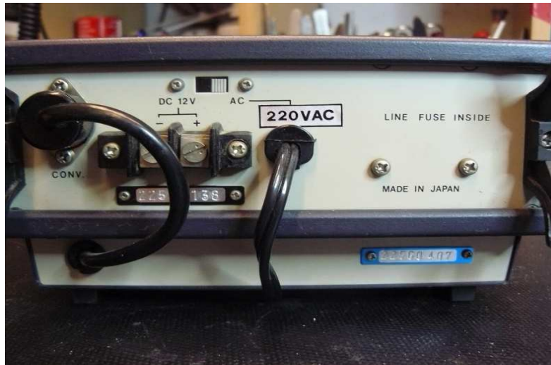
Lato posteriore con commutatore AC / DC
