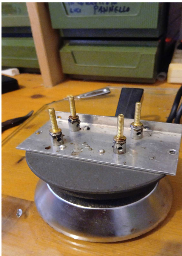
saldatura dei morsetti alle viti di fissaggio
