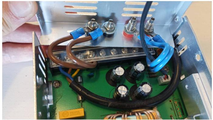
Come si evince dalle foto, dopo l'apertura dell'involucro attraverso la rimozione delle viti di cui è dotato, ho realizzato le connessioni 220 Vac e 12Vcc dal dietro della morsettiera, ovvero dal lato interno dell'alimentatore così da evitare di lasciare esposte al contatto umano... zone potenzialmente sotto tensione, nonché dare, attraverso l'applicazione delle prese a "banana", praticità, pulizia e ordine all'insieme.
