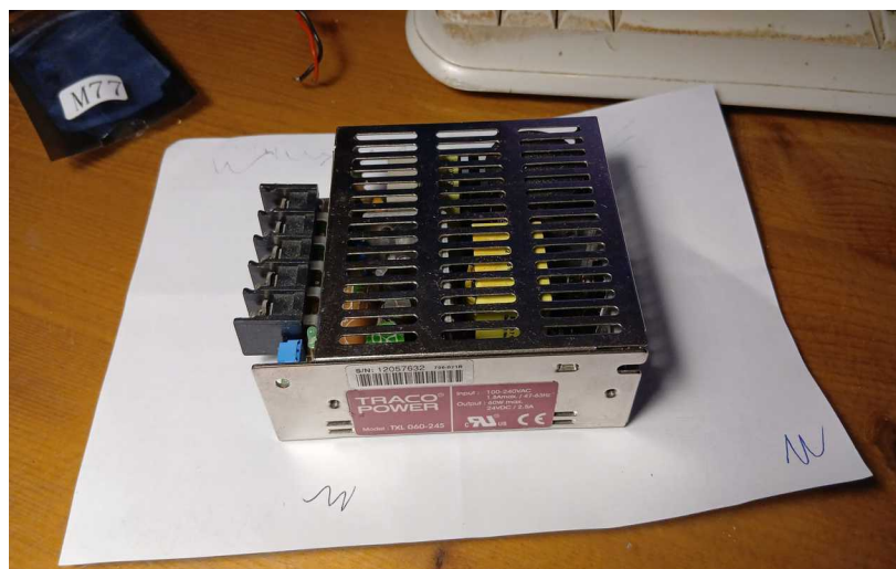
Alimentatore 230VAC \rightarrow 24VDC
