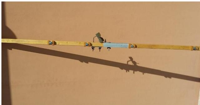
Per quanto riguarda il materiale utilizzato per la costruzione dei riflettore, del radiatore e dei direttori, ho utilizzato dell'alluminio da 4 mm ricoperto in pvc, recuperato presso un rottamatore della zona ( probabilmente una bobina scartata dall' ente per l'energia elettrica Nazionale, impiegata per le linee elettriche ad alta tensione) leggero e molto resistente, tuttavia vanno benissimo anche le barrette tonde di alluminio, ottone o rame pieno diametro 5 mm reperibili in qualsiasi
