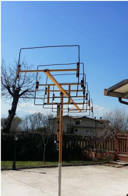
Passiamo alla fase costruttiva: Il boom, lungo 2 metri è composto da un quadrello di legno pieno di 20 x 20 mm. Con separazione a metà dello stesso e flangia di unione delle due parti in alluminio, con fissaggio della stessa con perno passante da 6mm e galletto di serraggio per una trasportabilità ed ingombro semplificati.
