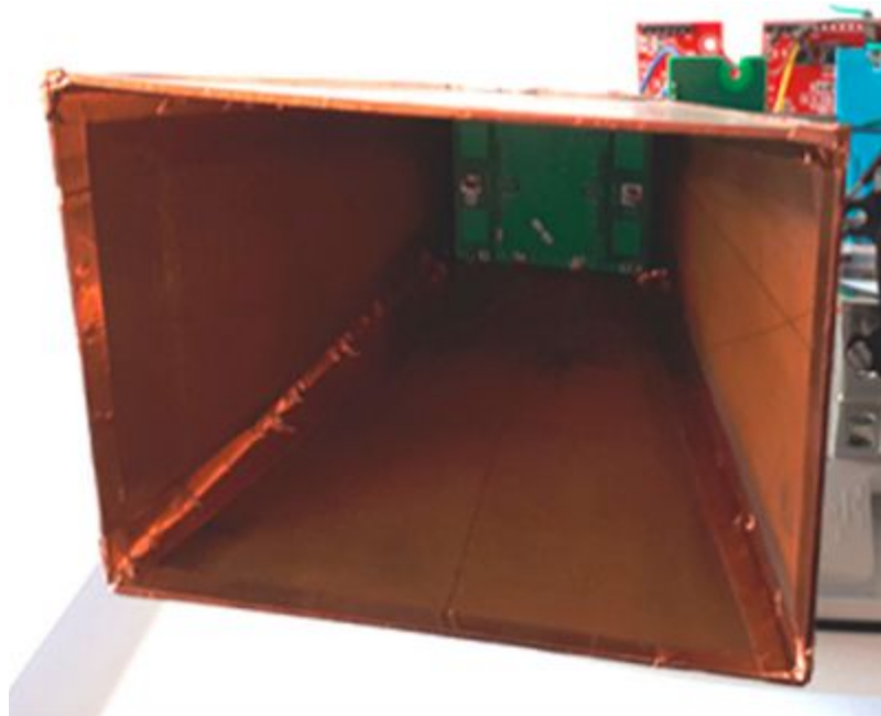
antenna HORN di cartone metallizzato
