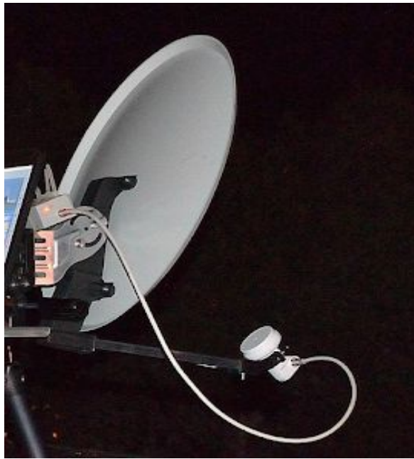
LNB in polarizzazione ORIZZONTALE: il cavo coax esce di lato!
