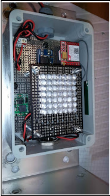
(il mio BEACON a 49 LED, aperto a sinistra, montato e funzionante nel sito a destra)
