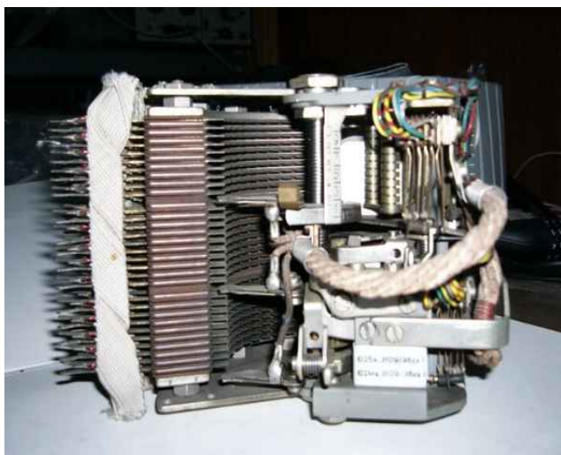
Selettore sollevamento rotazione Siemens, braccetti a-b-c, 100 uscite
