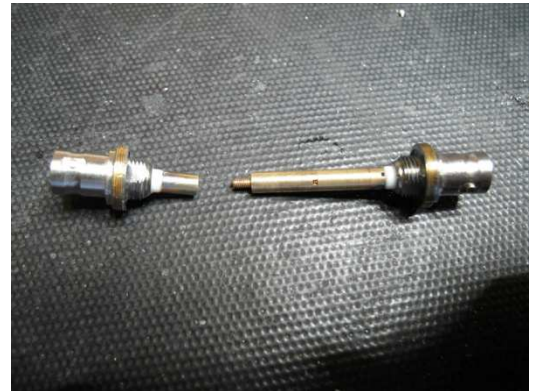
linea saldata ai connettori
